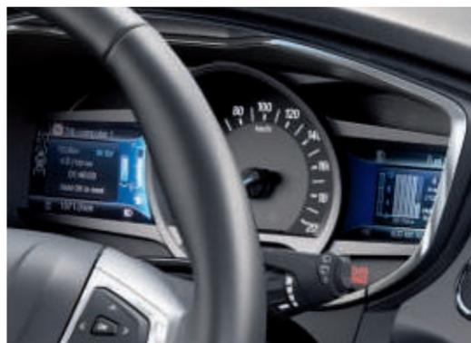
Instrument d'affichage combiné TFT couleur 10" avec HEV SmartGaug®
