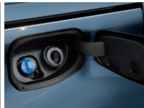
Système de remplissage du réservoir Ford Easy Fuel
