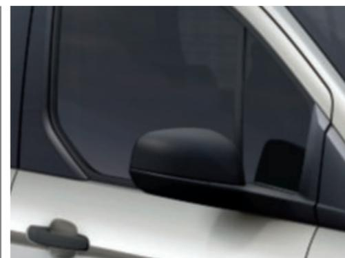
Rétroviseurs extérieurs chauffants et réglables électriquement, format fin
